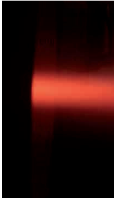
El prototipo del motor helicón, objetivo del proyecto HPH.COM, se ensaya en una cámara de vacío para verificar su diseño y actuaciones. A la izquierda, se observa la creación de plasma en la cámara. A la derecha, vemos el chorro de gas eyectado. (Imágenes cedidas por la Universidad de Padua, institución que coordina la investigación.)
